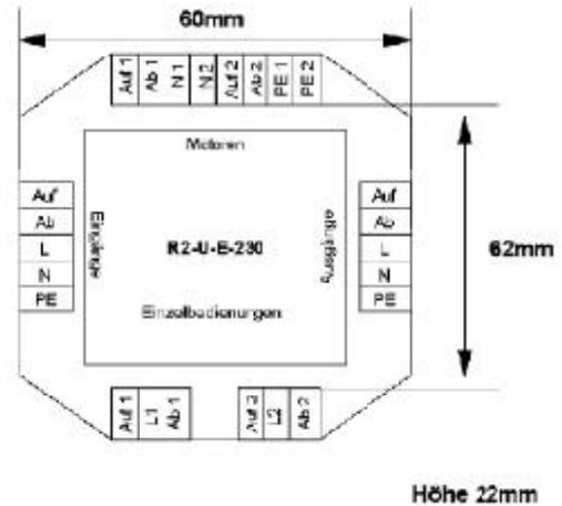
Trennrelais für zwei Motoren
